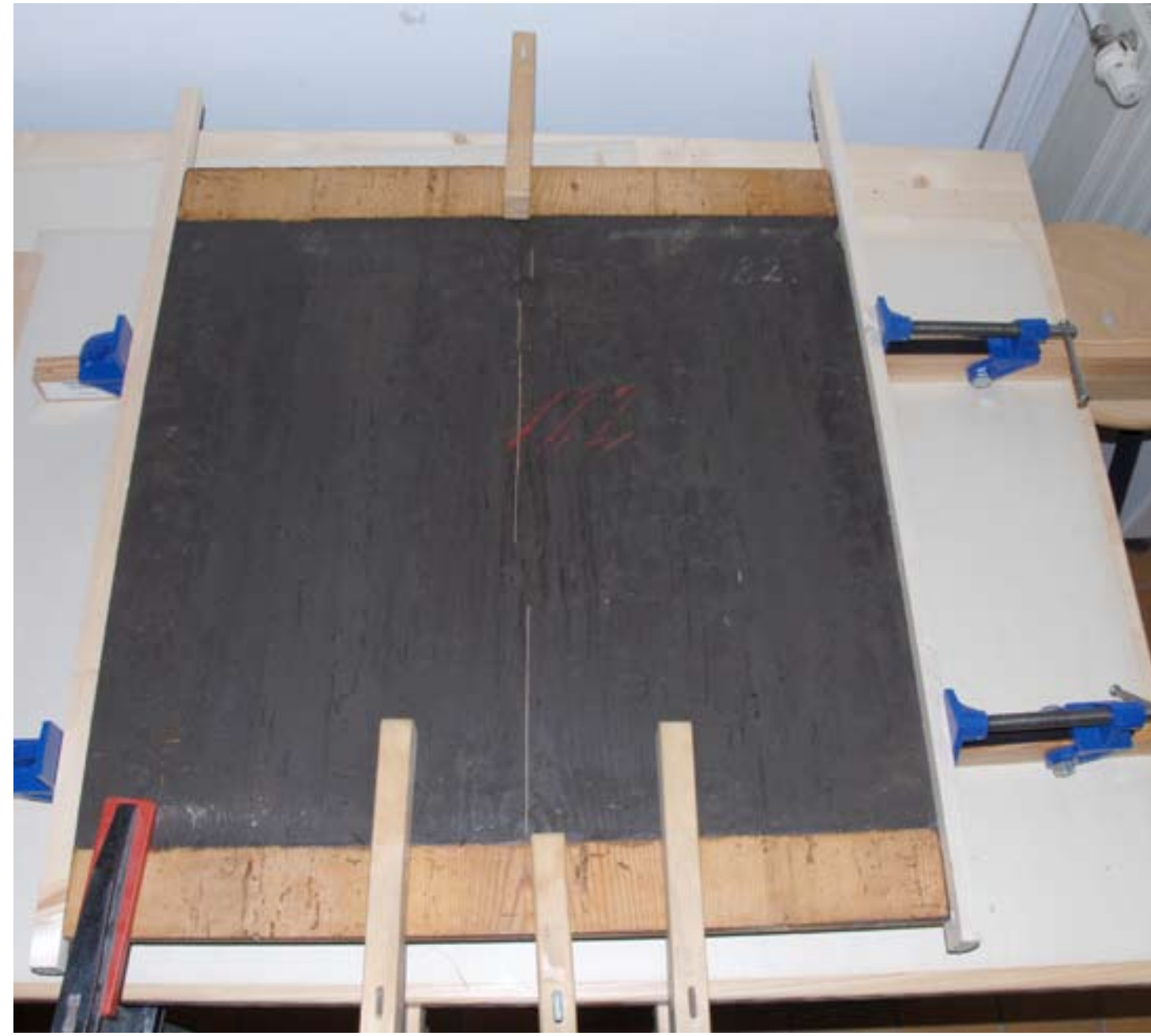
Inv.-Nr. 122: die hellen Bereiche in der Fuge zeigen die eingeleimten Furnierspäne
