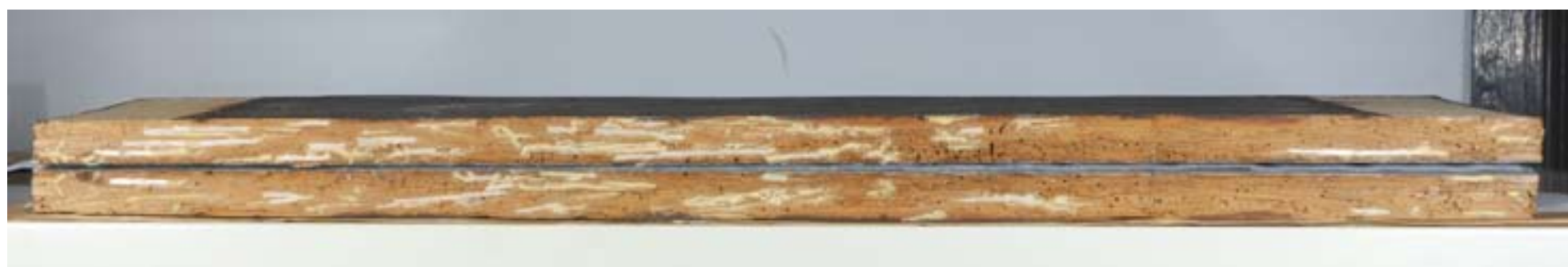
Inv.-Nr. 118: Leimfuge mit Holzergänzungen in den geschädigten Bereichen
