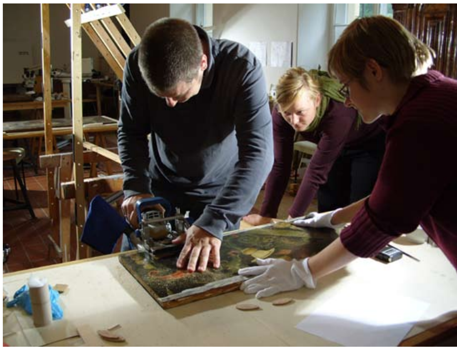
Inv.-Nr. 118: Einfräsen der Nut für die Aufnahme der Holzblättchen
