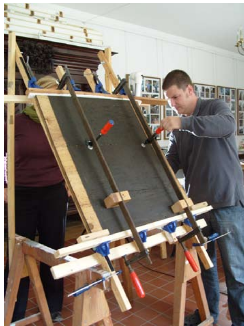
Inv.-Nr. 118: Einfräsen der Nut für die Aufnahme der Holzblättchen
